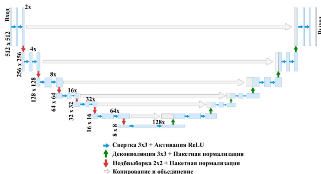
Рис. 1. Модернизированная сеть U-Net для решения задачи детектирования речных разливов по данным КА Sentinel-2 и Landsat-8.
